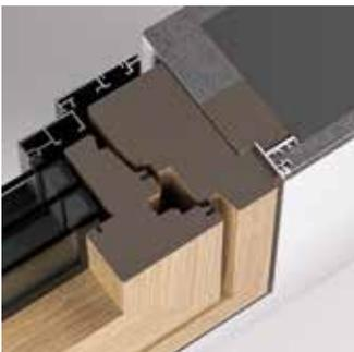
Aluminiumprofile für wandbündige Fenster-, Einbau-, und Küchenelemente, Profil wird auf das Blindfutter geklebt und gewährleistet dadurch eine Entkoppelung der gesamten Vibrationen, die abgeschrägte Kante gewährleistet perfekte Kantenausbildungen und filigrane Schattenfugen, perfekte Putz- und Trockenbauanbindung durch das in das Zargenprofil einklickbare Putznetz, dadurch entsteht eine feste Verbindung zwischen Türzarge und Mauerwerk/Trockenbau und ver- hindert somit Haarrissbildungen
