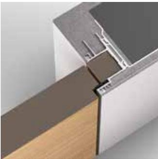
Konfektionierte Aluminiumprofile für wandbündige Türkonstruktionen mit perfekter Kantenaus- bildung und filigraner Schattenfuge, ohne Probleme mit Haarrissbildung, die mit einer unästheti- schen Acrylfuge verschlossen werden müsste, das mitgelieferte Putznetz wird in das Zargenprofil eingeklickt und stellt somit eine feste Verbindung zwischen Türzarge und Mauerwerk / Trocken- bau her, für eine schnelle und fachgerechte Montage sind Montagebügel und Eckverbinder vor- gesehen, mit Montageanleitung
