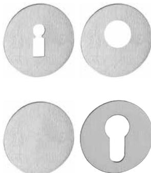
Edelstahl matt, Aussenrosette Höhe 2 mm mit 2 Gewindenocken M4 x 14 mm, Innenrosette: Unterplatte 1 mm mit 2 Schraubenlöchern und Magneten und Abdeckplatte 1 mm mit Randdicke 2 mm, Schraubenlochdistanz 38 mm, ohne Schrauben, Grösse 53 x 2 mm
