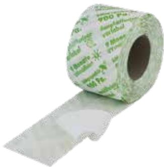
Wird zur Überbrückung der Fuge zwischen Fenster/Tür und Bauwerk im Innen- und Aussenbereich nach dem Prinzip des diffusionsfähigen Feuchtausgleichs eingesetzt, wasserundurchlässig, dampfdiffusionsvariabel, UV-stabilisiert (bis zu 9 Monate), einseitig selbstklebend, alkalibeständig, beständig gegen Mikroorganismen, überputz- und überstreichbar
