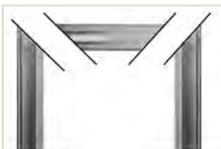
1. Profile in der entsprechenden Länge in Gehrung schneiden.
